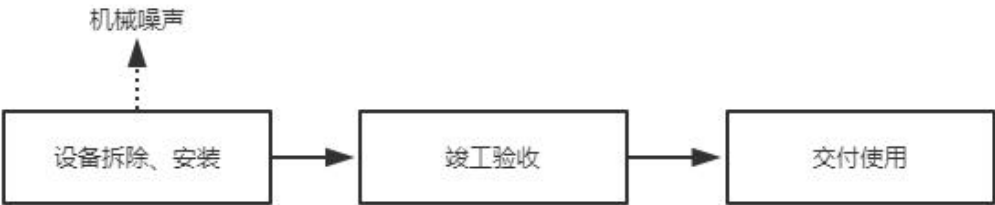
图2-3 施工期工艺流程及产污环节图
