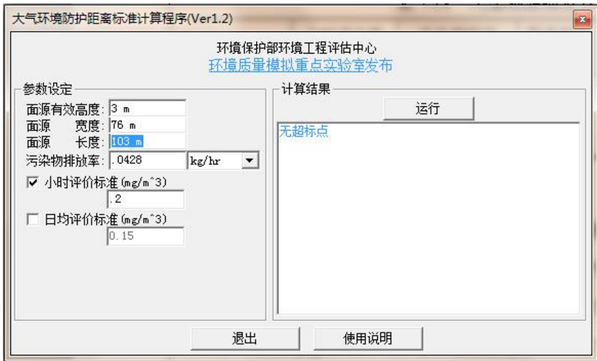
图 7-1 氨气无组织排放大气防护距离计算结果图
