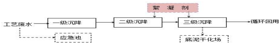
图 7-1 废水处理工艺流程
