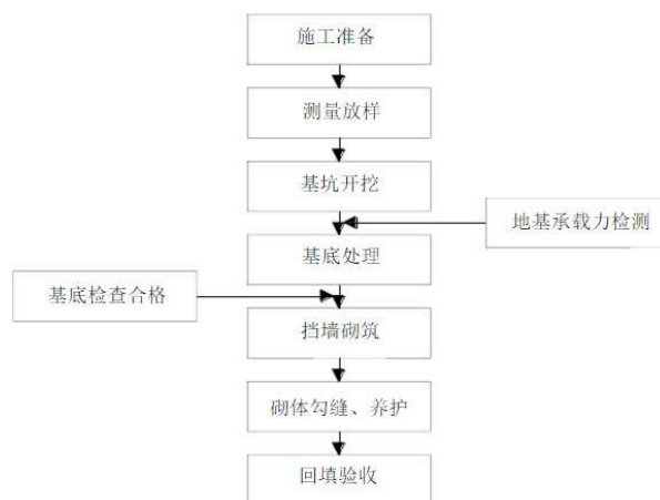
图 5.1-3 浆砌石施工工艺流程
