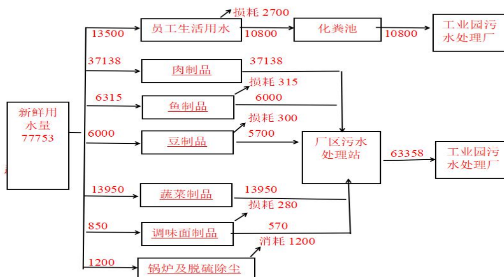
图 2-1 项目水平衡图（单位：m³/a）
