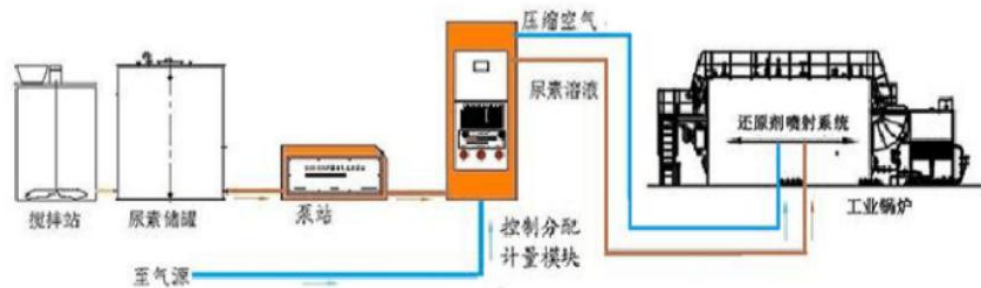
图 2-2 SNCR 炉内脱硝装置的工作流程示意图
