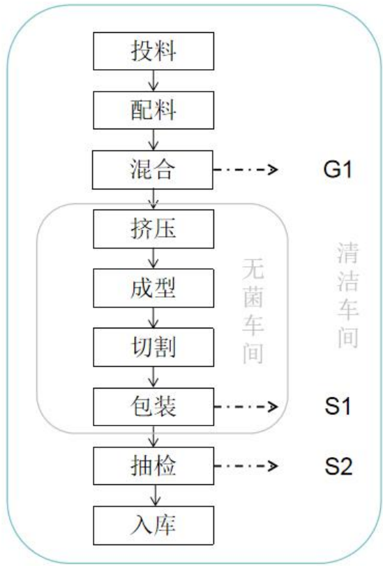
图 2-5 高湿蛋白工艺流程及产污节点图 生产工艺流程简述：
