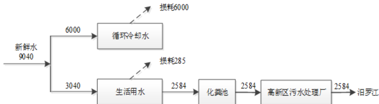
图 3.2-1 建设项目用水量平衡图（单位： \text{m}^3/\text{d} ）
