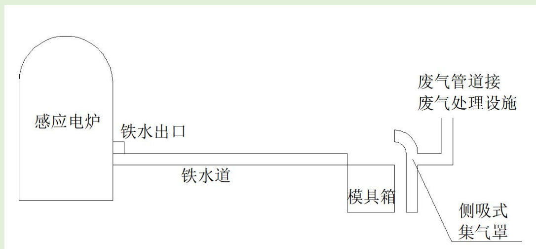
图 4-1 浇筑区集气罩安装示意图
