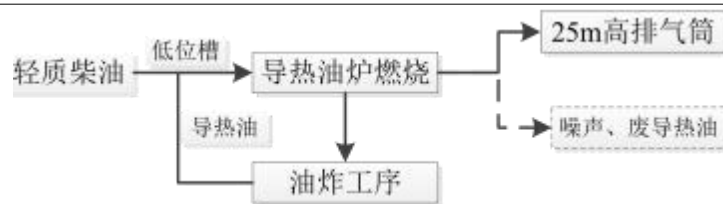
图 2-4 导热油炉工艺流程及产污节点图
