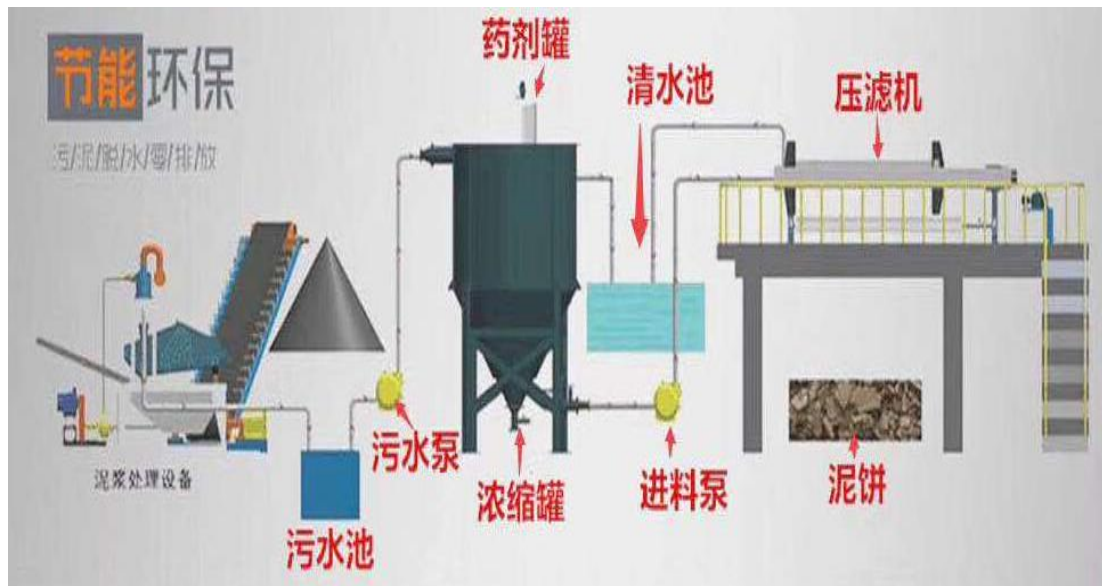
图 4-1 项目污水处理设施处理工艺流程图
